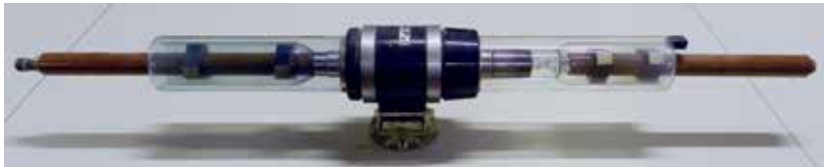
Fig. 6. Radiotherapiëröntgenbuis voor 400 kV van Philips. Deze buis komt vermoedelijk uit een proefserie en is uiteindelijk niet in productie gegaan.
