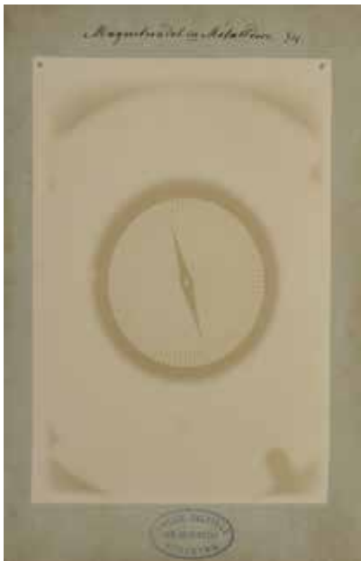
Figuur 9. Röntgenfoto van een kompas in een gesloten metalen doos. Deze foto toont aan dat, als het blik van de doos niet al te dik is, de röntgenstralen makkelijk door het blik van de doos heen gaan en zo de kompasnaald zichtbaar wordt.
