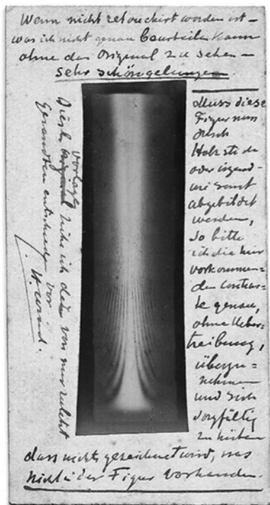
Figuur 4. Diffractiepatroon van röntgenstralen door een wigvormige spleet met het commentaar van Röntgen (uit: het familiearchief Wind).
