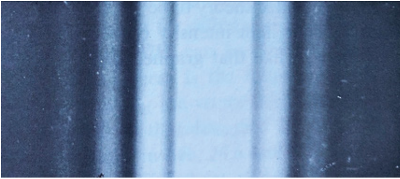
Figuur 1. Diffractiepatroon van gewoon licht door een smalle spleet (uit: Introduction to college physics , Harvey E. White, 1968).
