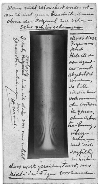
Figuur 4. Diffractiepatroon van röntgenstralen door een wigvormige spleet met het commentaar van Röntgen (uit: het familiearchief Wind).
