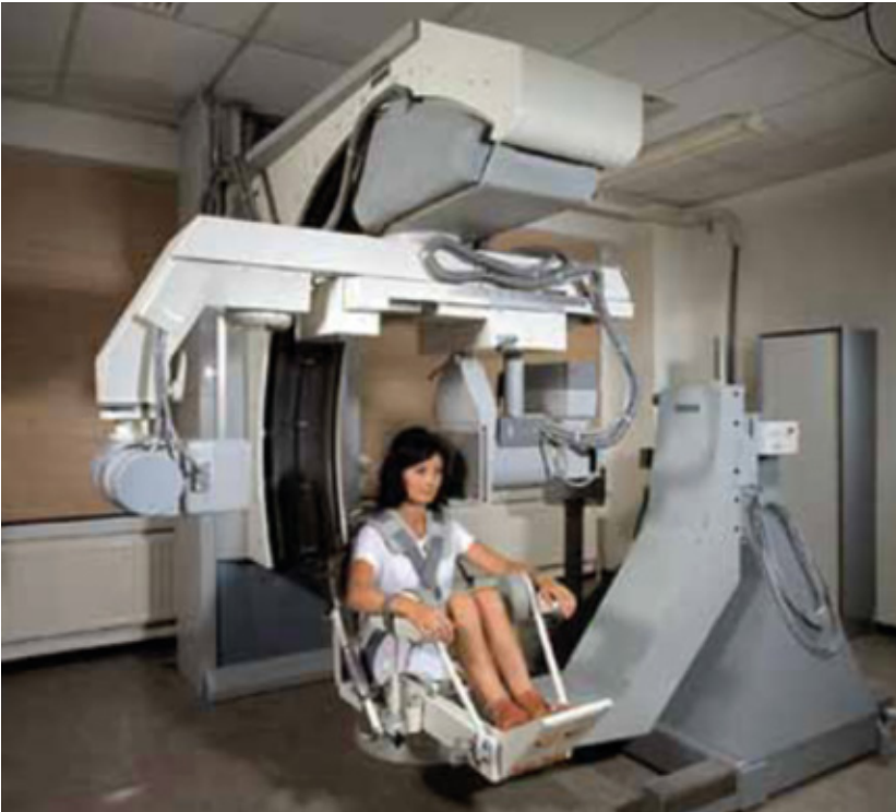
Figuur 3. Diagnost N ten behoeve van pneumo-encefalografie.
